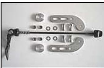
Alcune ditte forniscono dei kit adattatori per montare il portapacchi anche in assenza dei fori filettati sui forcellini posteriori. In questo caso è necessario anche cambiare il bloccaggio posteriore che avrà un' asta leggermente più lunga.
