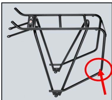
La soluzione ottimale per affidabilità e robustezza, è data dai portapacchi con attacco a quattro punti. Con il cerchietto rosso (nella figura a lato) è evidenziata la presenza della terza asta che non ha funzioni strutturali ma serve esclusivamente ad impedire che le borse, oscillando, tocchino nella ruota posteriore.
