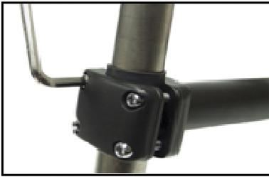
Robusti e abbastanza affidabili, sono i modelli a sbalzo che sono fissati al tubo reggisella con bulloni o con un bloccaggio a leva
