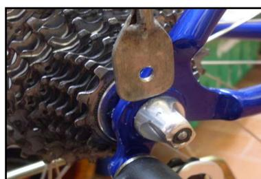
*Portapacchi a sbalzo fermato al tubo reggisella e sostenuto con due astine posteriori auto costruite, inserite tra il bloccaggio ruota e telaio. La soluzione presentata qui sopra è stata utilizzata con successo per la P-B-P 2007 e per la 1001Miglia del 2008.*
