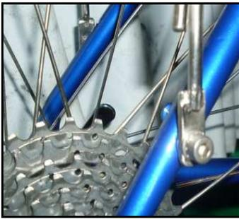
Generalmente le moderne biciclette da corsa **non hanno** i fori filettati per il fissaggio dei portapacchi, a meno che il telaio non sia stato realizzato, da un costruttore artigianale, su richiesta specifica come questo che si vede nella foto accanto.
