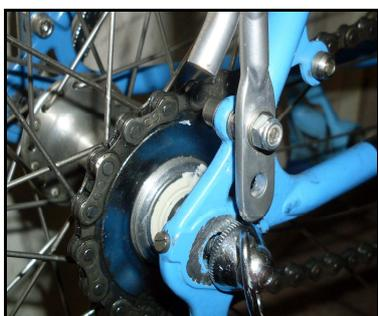
In passato, quando molte strade erano sterrate si montavano i parafranghi per gli allenamenti invernali e i telai avevano anche un foro filettato sulla parte superiore del forcellino posteriore che permette, mettendo una vite leggermente più lunga, di montare anche un portapacchi.
