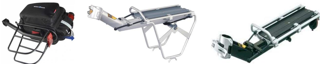
L'utilizzo del portapacchi a sbalzo, comporta sempre una minima oscillazione del carico che è avvertibile durante la guida, specialmente su percorsi stradali sconnessi. Per contro è possibile utilizzare alcuni accorgimenti per aumentare la stabilità
